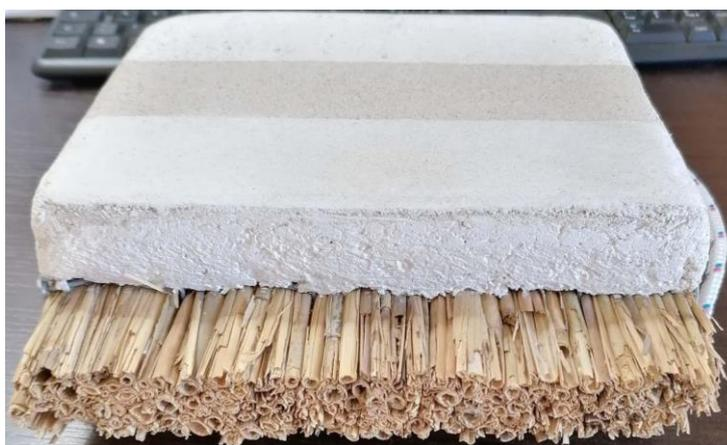
*Figura 3.2 – Vista in sezione di una porzione del pannello con strato di intonaco superficiale (Fonte: archivio LACEP)*
