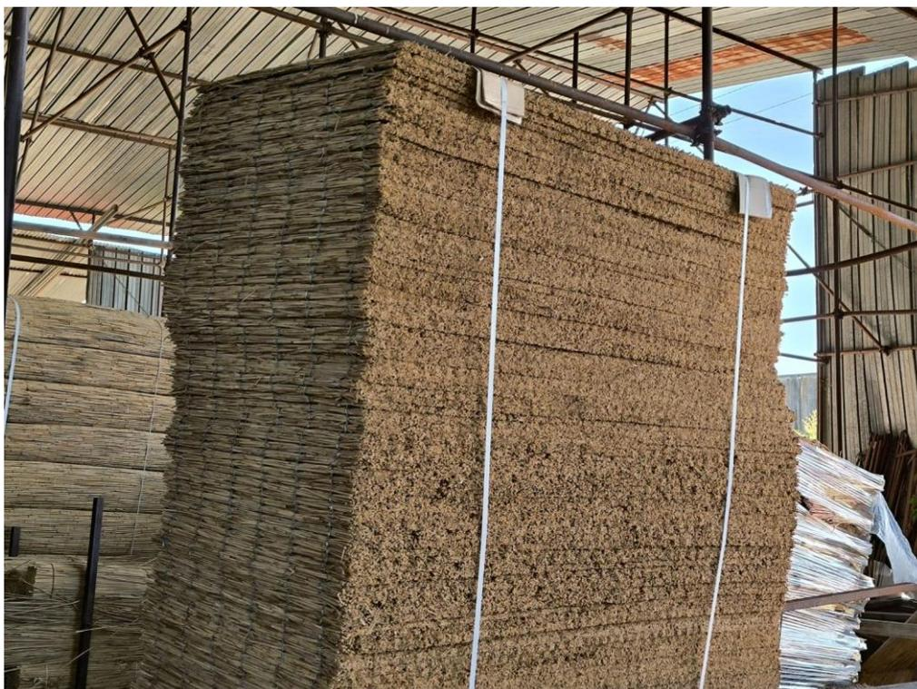
*Figura 4.3 – Pannelli termo-isolanti impilati senza film plastico (Fonte: foto scattata nell’azienda LACEP)*
