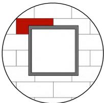
In corrispondenza di imbotti di finestre e porte i pannelli isolanti devono essere posati intorno alle aperture tagliando il pannello a forma di L, in modo tale da garantire la continuità del materiale in corrispondenza dell'angolo.
