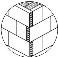
Per ottenere angoli esterni precisi, sfalsare tra un corso e l'altro le teste dei pannelli, avendo cura di posare il pannello isolante con un oggetto adeguato e poi posare l'altro pannello, appoggiandolo al primo. Fare attenzione a non utilizzare pannelli di dimensione inferiori alla metà del pannello stesso.
