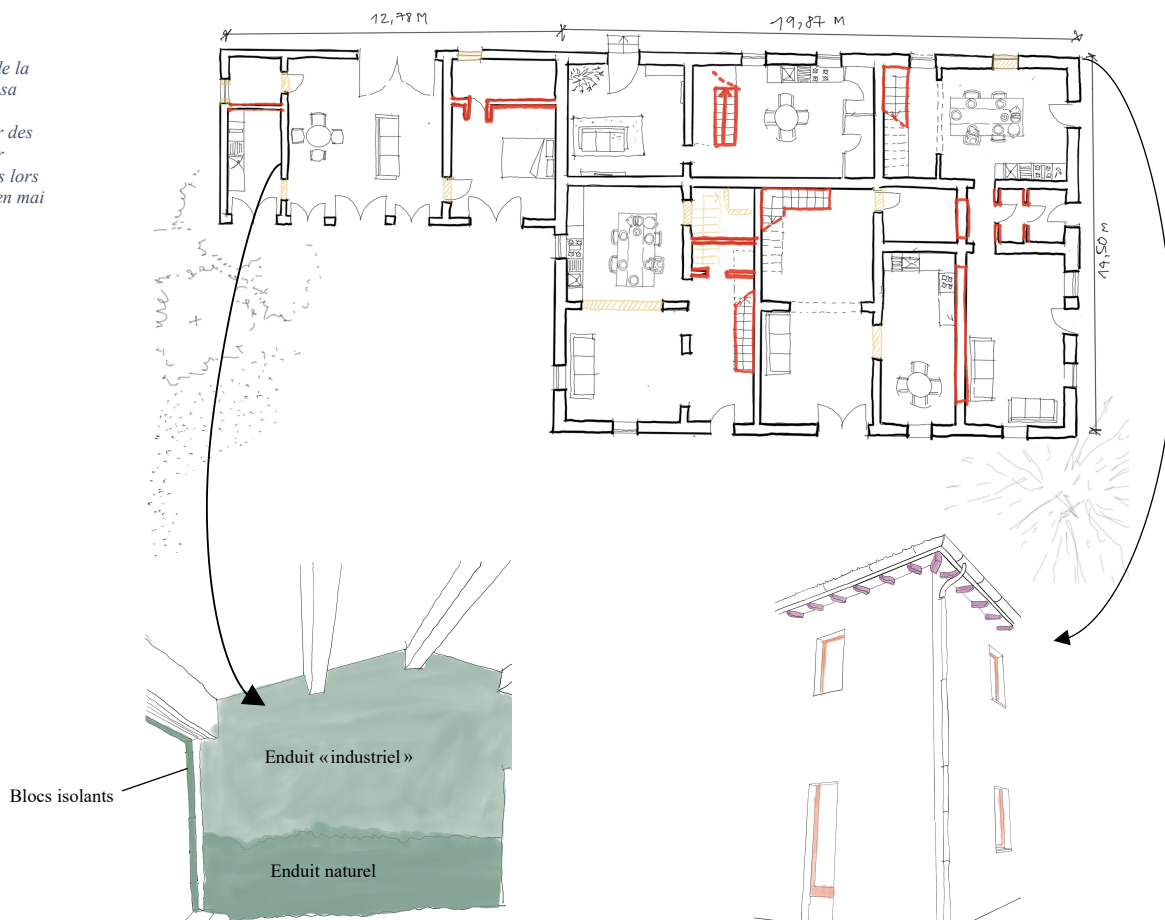
Figure 22. Enduits mises sur les murs intérieurs. Dessin personnel.
