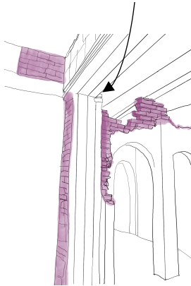
Figure 26. Murs en pierre ronde et brique. (Matériau locale). Dessin personnel
