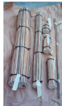
mento dell'opportuno spessore e fermate con semplici fascette. L'assemblaggio non discosta molto dalle strutture a traliccio con solai a secco ma risulterà un edificio a portanza continua, armata con le travi e con pannelli a doppia maglia ortogonale incrociata. Utilizzando le stuoie come cassero, le pareti saranno poi riempite con malta di calce-canapulo-argilla e il cassero servirà da supporto per l'intonaco.
