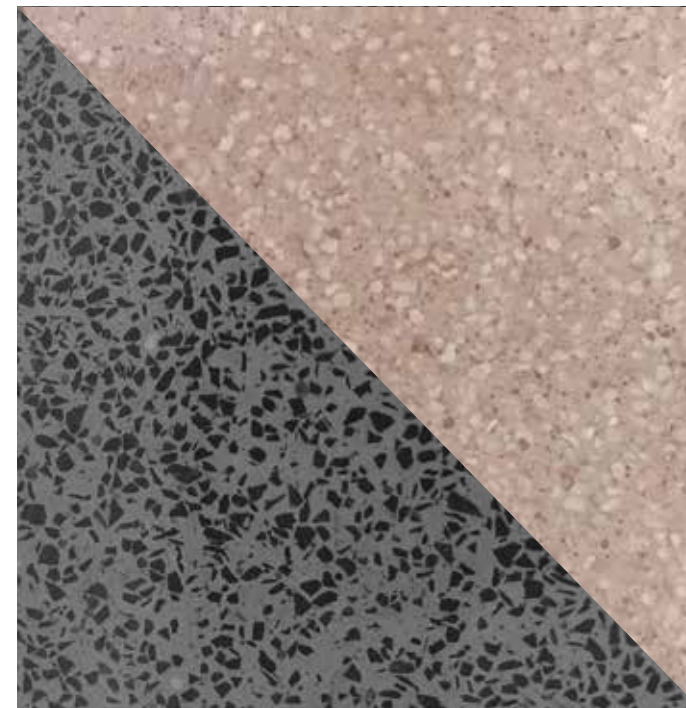
ISOPLAM, TERRAZZOVERLAY Pavimento alla veneziana extra-sottile realizzato con una miscela di marmo italiano e polvere cementizia. Le nuove tecnologie consentono di ottenere uno spessore di soli cm 0,4-0,8 sia nella versione per interni levigata e lucida, sia in quella per esterni opaca, bocciardata e antiscivolo. ● Extra-thin Venetian flooring made from a mixture of Italian marble and powdered cement. New technologies make it possible to recreate the traditional terrazzo effect in a thickness of just 0.4-0.8 cm in both the smooth, polished version (for interiors) and in the satin, bush-hammered, non-slip version for outdoor areas. isoplam.it
