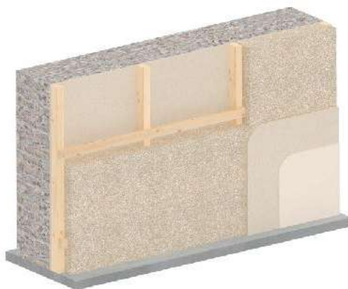
1. Controparete su struttura muraria esistente
