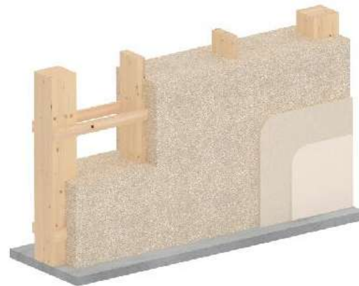
2. Tamponamento su struttura lignea di nuova costruzione
