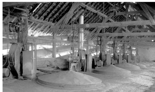
Fig. 22 - Forni a tino per la produzione di cemento naturale (Cimet Vicat, Grenoble)
