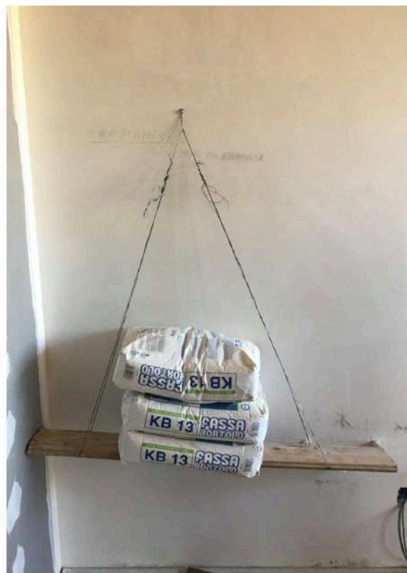
Fig. 4.33 Prova a carichi concentrati - 75 kg
