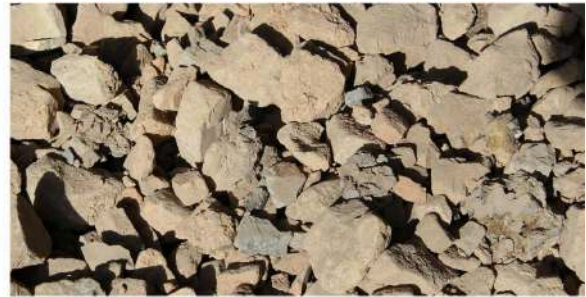
Fig 2.5 Rocce calcaree in uscita dai forni (calce viva)
