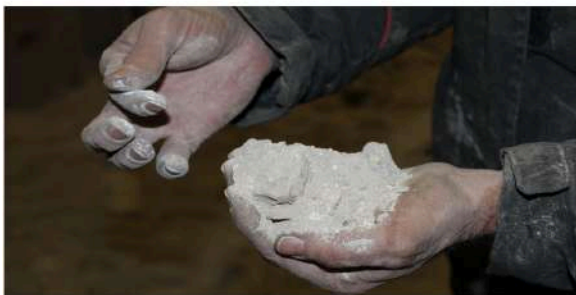
Fig 2.8 Calce idrata (spiegimento per aspersione)
