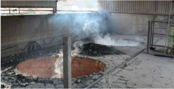
Fig 2.2 Forni verticali per la cottura
