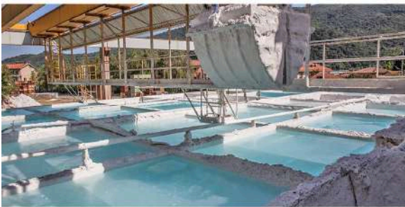
Fig 2.6 Vasche immersione calce viva (bancadellacalce.it)
