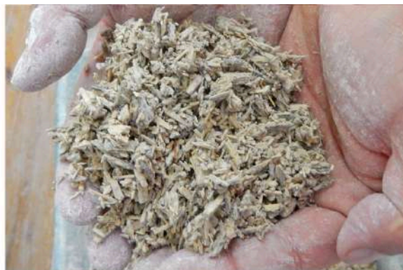
Fig. 2.23 Miscela di calce e canapa
