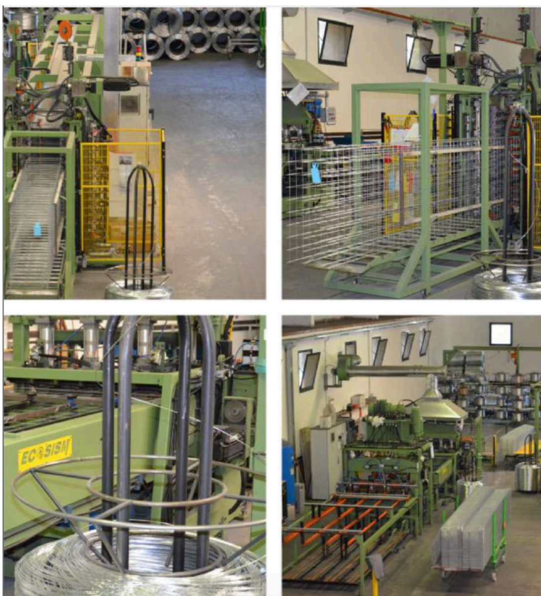
Fig. 3.1 Processo di produzione moduli tridimensionali in acciaio zincato presso l'Azienda Ecosism – Advanced Building Technology, ecosism.com
