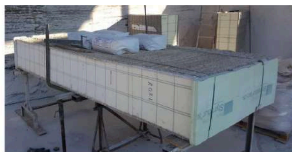
Fig 3.11 Quinta prova di carico (100 kg)
