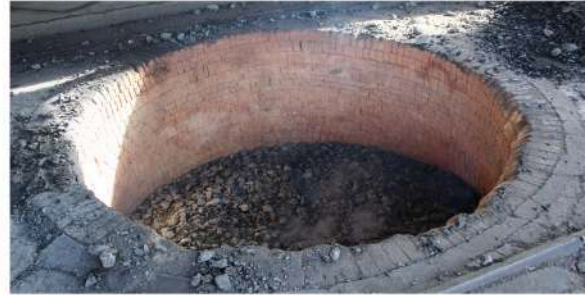
Fig 2.3 Introduzione rocce calcaree nei forni
