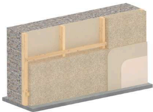
Fig. 2.24 Controparete in calce e canapa su muratura
